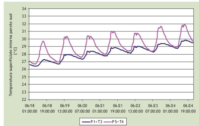
situazioni: il caso peggiore, cioè con elevati carichi interni dovuti ad un'apertura diurna delle finestre (e dunque all'ingresso di calore dall'esterno) e il caso migliore, cioè con finestre chiuse e schermate di giorno e una ventilazione notturna. In particolare, sono state confrontate le temperature superficiali interne registrate nelle pareti P1 e P5 e le temperature ope-
