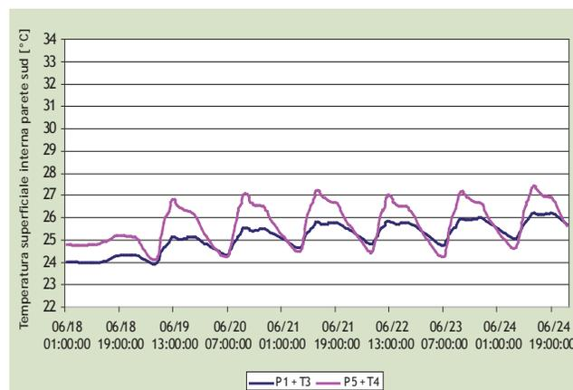
Tab. XIX - Temperature operanti registrate nei due casi (edificio con parete P1 e P5) con superficie vetrata pari a 1/8 dopo l'introduzione della ventilazione notturna + schermatura diurna.
