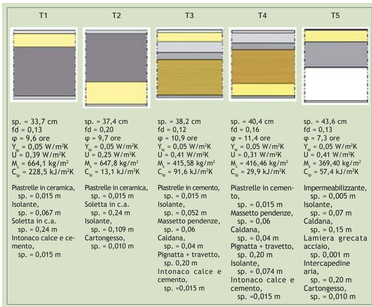
Fig. 7 - Cinque tipologie di coperture poste a confronto.
