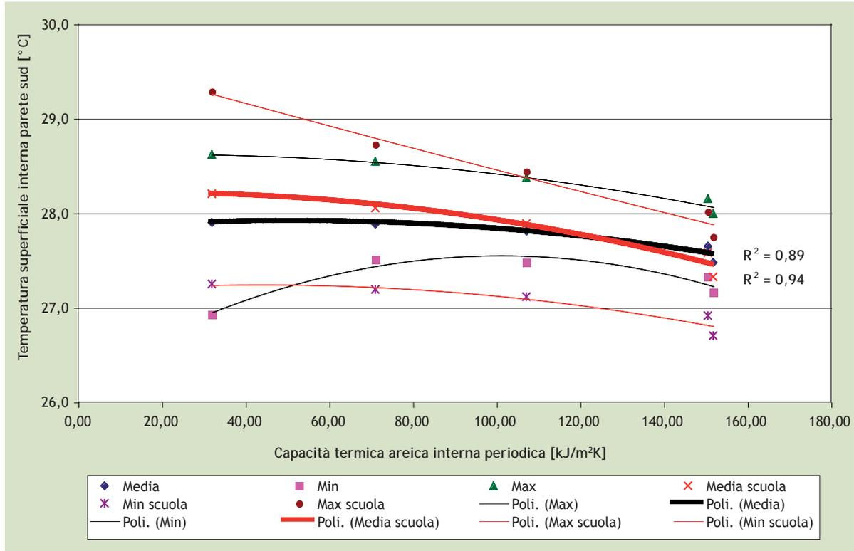
di temperatura superficiale (medi, massimi e minimi) sono molto elevati in estate, soprattutto nel caso di pareti esterne a bassa capacità termica areica interna periodica. La linea dei valori medi - rossa per la scuola e nera per la residenza - (e ancor più la linea dei valori massimi) ha un'inclinazione superiore nel primo caso, evidenziando proprio l'elevata incidenza della capacità termica areica interna periodica sulle temperature superficiali quando i carichi interni sono elevati.
